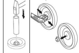
D: Montage/Demontage Hutclip: Der Hutclip läßt sich mit einer Zange abziehen. GB: Mounting/Removing hat clip: You can pull off the hat clip with a pair of tongs very easily. F: Montage/Démontage du clip à chapeau: Le clip peut à présent être retiré à l'aide d'une pince.
