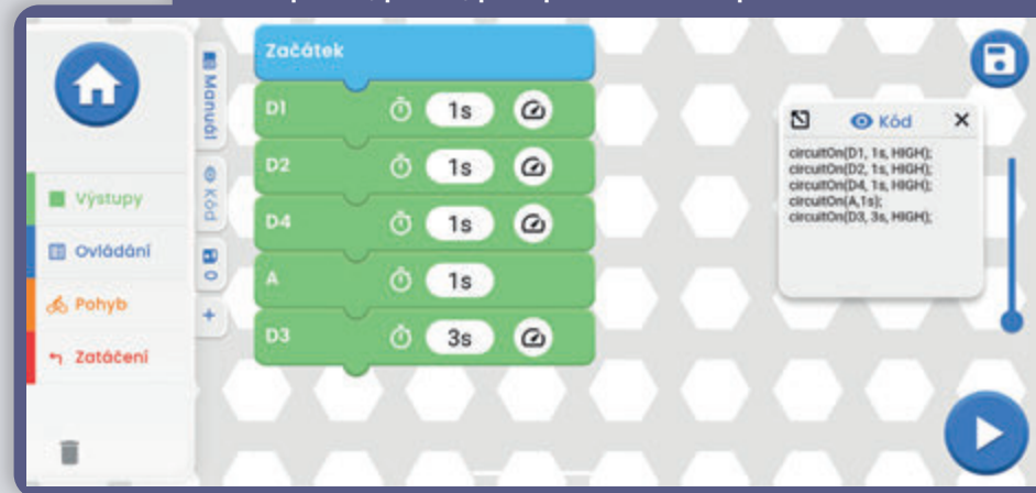
Obrazovka Boffin aplikace: Odpočet: Rozsviňte jednu LED diodu, poté 2, poté 3, pak spusťte sirénu a pak ventilátor.
