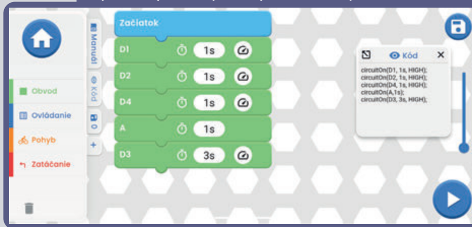
Obrazovka Boffin aplikácie: Odpočet: Rosviette jednu LED diódu, potom 2, potom 3, potom spustíte sirénu a potom ventilátor.
