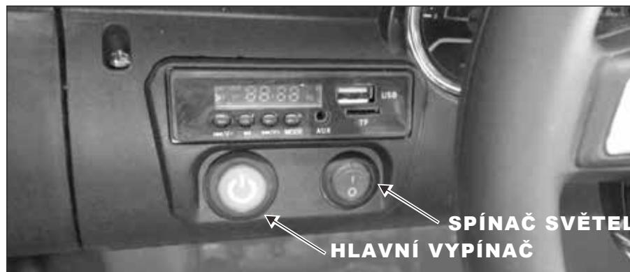
b) Spínač 1/0 je spínač osvětlení, přepněte přepínač do polohy „1“ světla svítí, přepněte přepínač do polohy „0“ světla jsou vypnuta.
