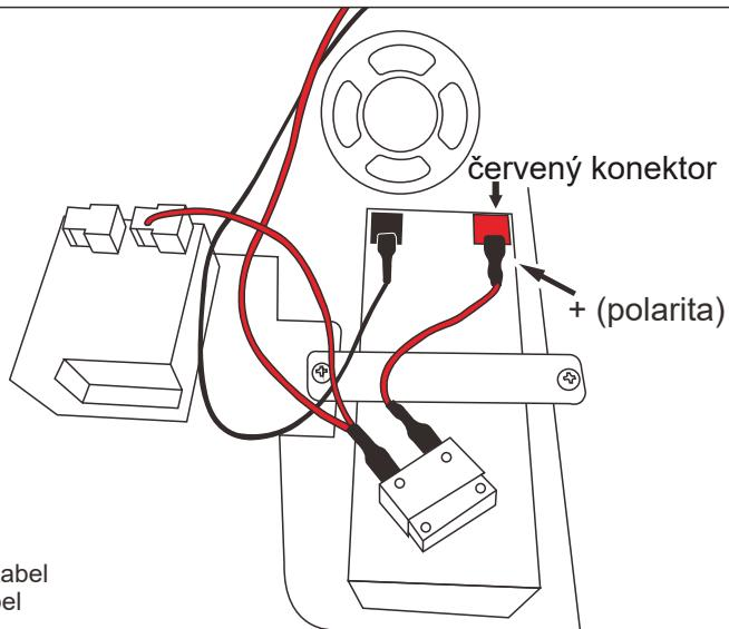
Připojení napájení: zapojte červený napájecí konektor do červeného konektoru na baterii.
