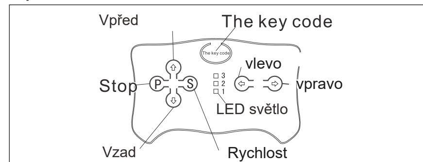
Provoz dálkového ovladače má vždy přednost před funkcí pedálů. Nožní pedál při ovládání dálkovým ovladačem nefunguje.
