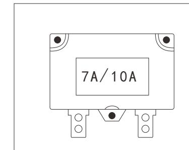
Pokud proud přesáhne 7 A nebo 10 A, obnovitelná pojistka automaticky vypne napájení po dobu 5 až 10 sekund, potom bude napájení obnoveno.
