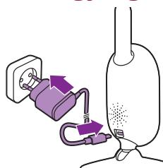
Csatlakoztassa a hálózati adaptort a bébiegységhez, majd csatlakoztassa az adaptort a fali konnektorba.
