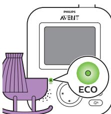
Kad je aktiviran način rada ECO, zaslon i zvuk roditeljske jedinice isključit će se ako se tijekom 20 sekundi ne otkrije zvuk. Indikator ECO zasvijetli zeleno kako bi se naznačilo da je aktiviran način rada ECO. Dok je uređaj u načinu rada ECO, prijenos prikaza i zvuka je isključen.
