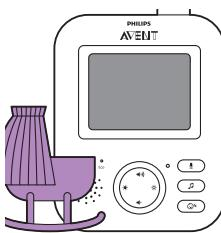
При активированном режиме VOX дисплей и звук родительского блока выключаются, если в течение 20 секунд не будет зафиксировано никаких звуков.
