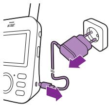
**3** Lülitage keskseade välja, eemaldage toiteadapter keskseadmost ning ühendage toiteadapter pistikupesast lahti.
