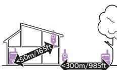
Рабочий диапазон составляет 50 метров в помещении и 300 метров на открытом пространстве. Рабочий диапазон радионяни варьируется в зависимости от окружающих условий и помех различного вида. Мокрые и влажные материалы создают настолько большие помехи, что сокращение рабочего диапазона составит до 100%.
