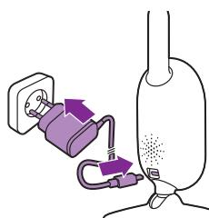
Sisestage toiteadapter beebleadmesse ja adapter seinakontaktu.
