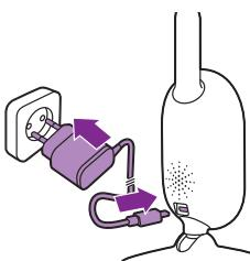
Uključite adapter napajanja u jedinicu za bebu, a adapter u zidnu utičnicu.
