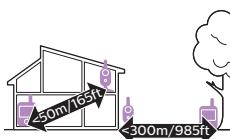
Робочий діапазон становить до 50 метрів у приміщенні та до 300 метрів на відкритому просторі. Робочий діапазон системи контролю за дитиною залежить від оточення та інших факторів, які можуть створювати перешкоди. Мокрі та вологі матеріали створюють настільки сильні перешкоди, що можуть зменшувати робочий діапазон до нуля.
