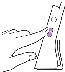
Когато бебешкият монитор е включен, можете да превключвате между тези 4 различни режима, като натискате бутона за режим отстрани на родителското устройство.
