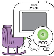
При активированном режиме ECO дисплей и звук родительского блока выключаются, если в течение 20 секунд не будет зафиксировано никаких звуков. Если индикатор ECO горит зеленым, значит, активирован режим ECO. В режиме ECO дисплей и передача звука выключены.
