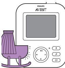
При активации режима AUDIO дисплей на родительском блоке выключается. Через три секунды дисплей полностью выключится, и строка состояния исчезнет.
