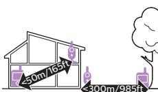
Provozní dosah je 50 metrů (165 stop) uvnitř budov a až 300 metrů (985 stop) venku. Provozní dosah elektronické chůvičky je proměnlivý v závislosti na okolí a na faktorech, které způsobují rušení. Mokré a vlhké materiály způsobují totik rušení, že ztráta dosahu stoupá až ke 100 %.
