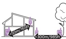
Работният обхват е до 50 метра / 165 фута на закрито и 300 метра / 985 фута на открито. Работният обхват на бебефона е различен в зависимост от околната обстановка и фактори, които причиняват смущения. Влажни и мокри материали причиняват толкова силни смущения, че загубата на работен обхват е до 100%.
