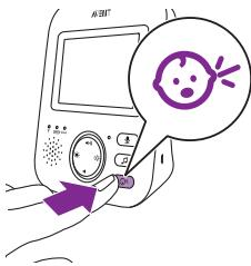
**1** Pritisnite gumb za osjetljivost da biste pristupili razinama osjetljivosti.
